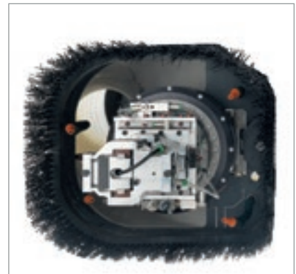
Grupo soprador de 4 saídas que podem ser utilizadas com os agregados de acabamento borda.
